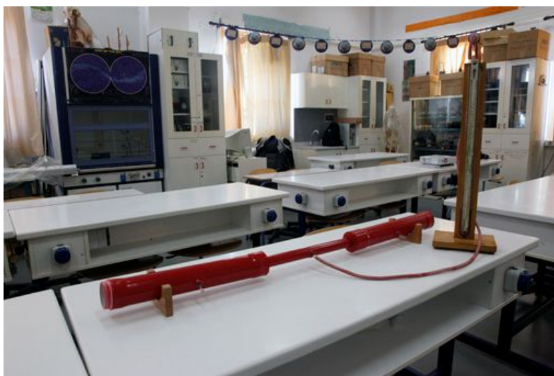
Εικόνα 5. Η τελική μορφή της διάταξης. Η μεσαία οπή έχει συνδεθεί με μανόμετρο.
