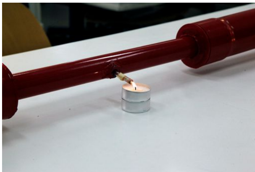
Εικόνα 7. Η φλόγα του κεριού τείνει να εισέλθει στο δεύτερο σωλήνα.
